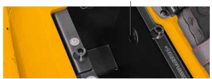
Knopf zur Öffnung der Batterieabdeckung
